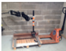
cobo MP41 porte outil monté sur rail
