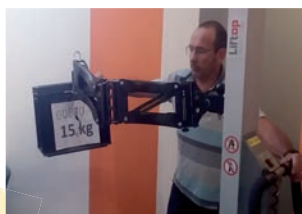
cobo MP41 porte caisse monté sur un chariot motorisé
